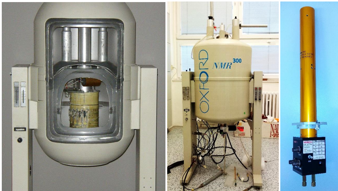
Obr. 1: Zleva: a) pohled do útroby NMR magnetu (supravodivá cívka umístěná v kryostatu – za provozu ponořená v kapalném heliu), b) náš NMR spektrometr Varian Mercury 300, c) NMR sonda, v níž probíhá vlastní měření vzorku (na předchozím obrázku je vsunuta zesponu do magnetu)
