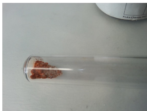
Obrázek 1. Příprava pentafenylcyklopentadienylového radikálu pro EPR měření.
