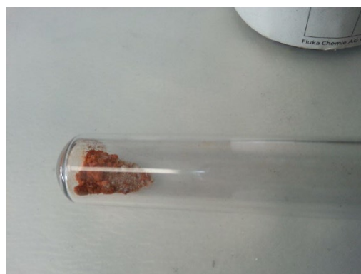
Obrázek 1. Příprava pentafenylcyklopentadienylového radikálu pro EPR měření.
