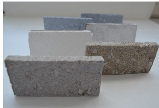
Obr.2: Ošetřené povrchy betonu a omítky.
